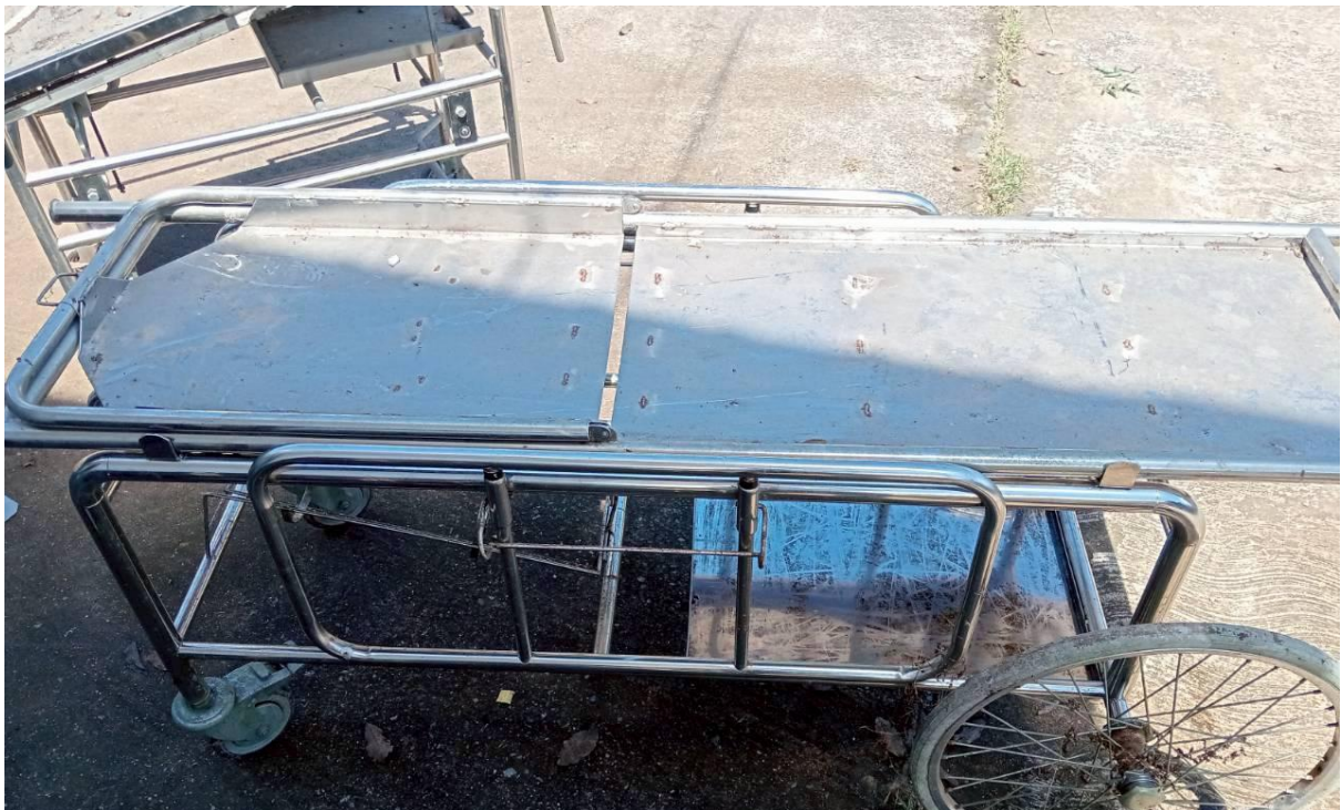
รถเข็นเปลหามสแตนเลสพร้อมที่ใส่แท็งค์ออกซิเจนทำด้วยท่อสแตนเลสกลม
